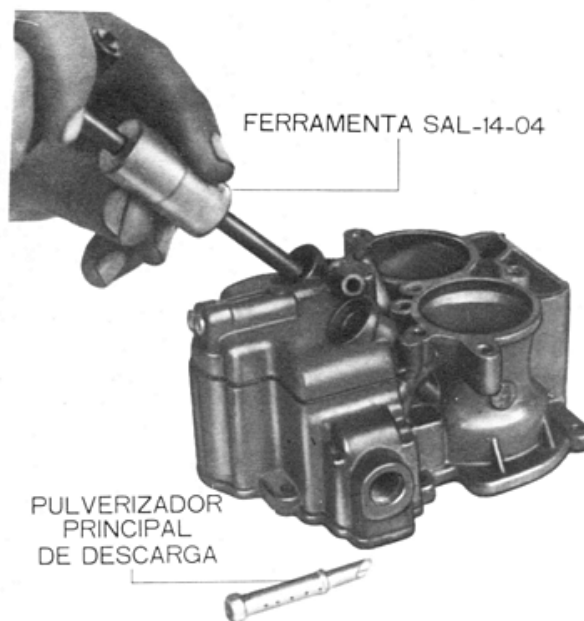
Fig. 9 — Remoção dos pulverizadores principais de descarga
