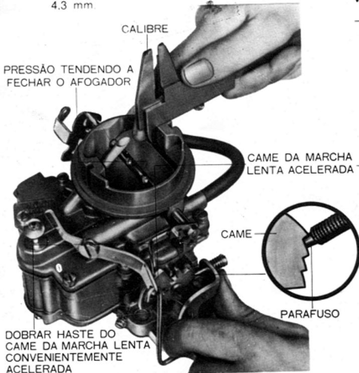
Fig. 21 — Regulagem da posição do came da marcha lenta acelerada
