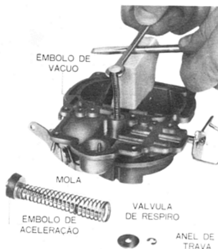
Figura 3 — Remoção do êmbolo de vácuo
