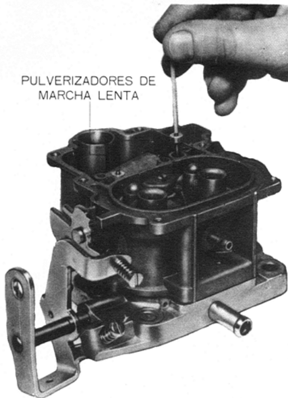
Fig. 4 — Remoção dos pulverizadores de marcha lenta
