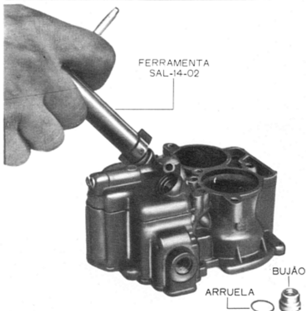
Fig. 7 — Remoção dos buejes dos gargulantes principais
