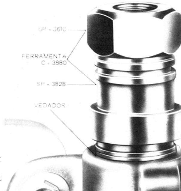
Fig. 7 — Instalação do retentor de graxa da árvore do setor
