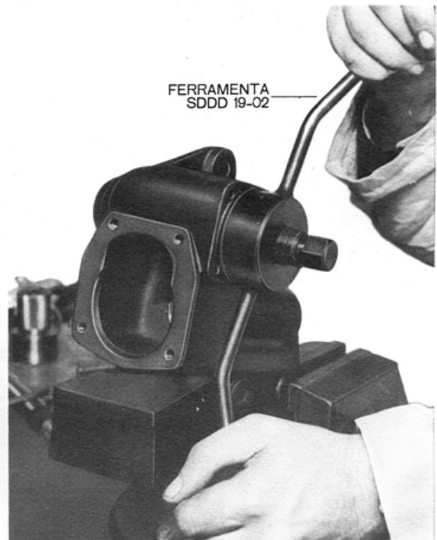
Fig. 2 — Remoção da capa do rolamento superior
