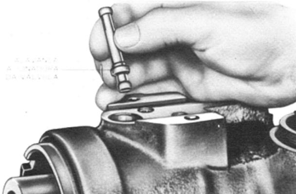
**Fig. 24 — Instalação da alavanca acionadora da válvula**
