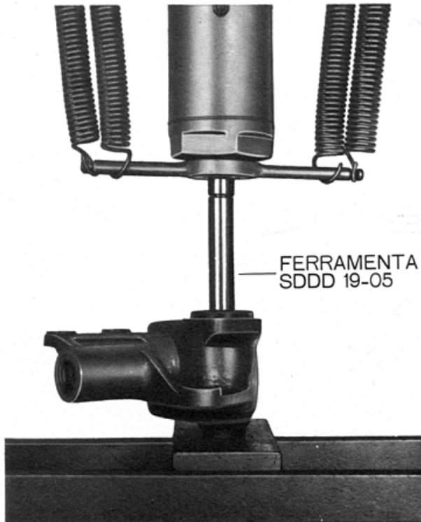
**Fig. 5 — Instalação da capa do rolamento superior da árvore do sem-fim**
