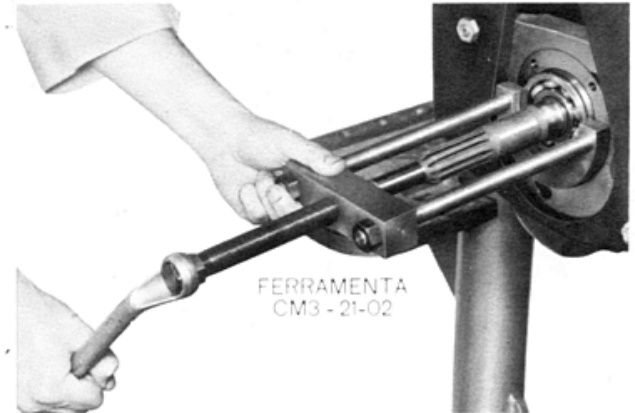
Fig. 13 — Remoção do rolamento da árvore primária
