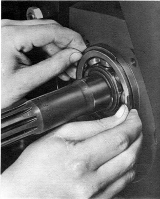
Fig. 11 — Remoção do anel externo do rolamento da árvore primária
