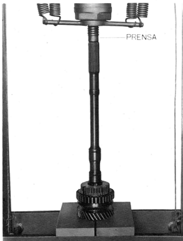
Fig. 9 — Remoção do conjunto sincronizador de 1. a velocidade
