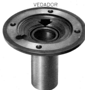
Fig. 10 — Flange retentora do rolamento da árvore primária
