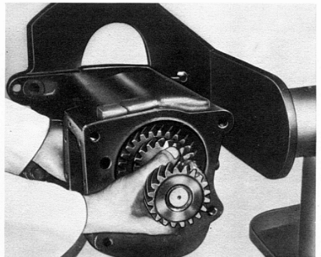
Fig. 13 — Remoção do trem de engr. intermediárias
