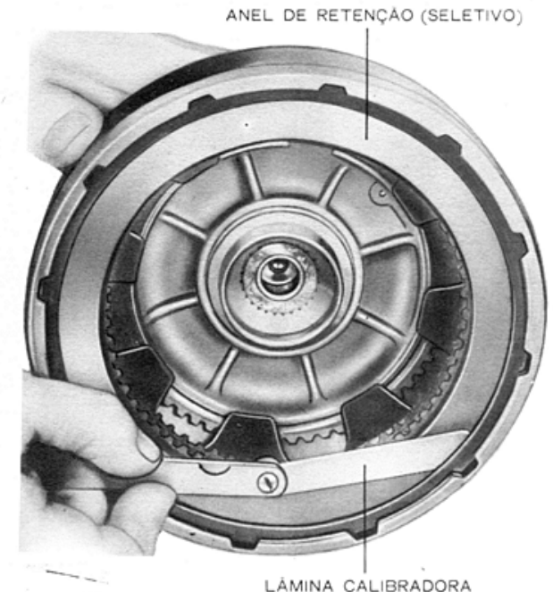
Fig. 55 — Medição da folga entre o anel de retenção e a placa de pressão da embreagem traseira
