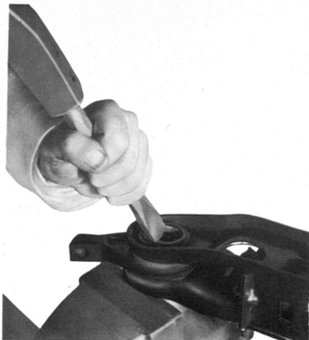
Fig. 18 — Corte da Bucha do Braço de Contrôlo Inferior
