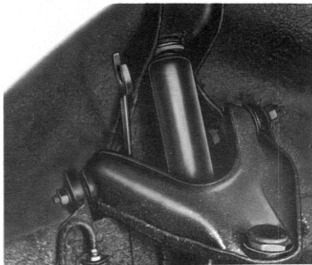
Fig. 9 — Regulagem do Camber e Caster
