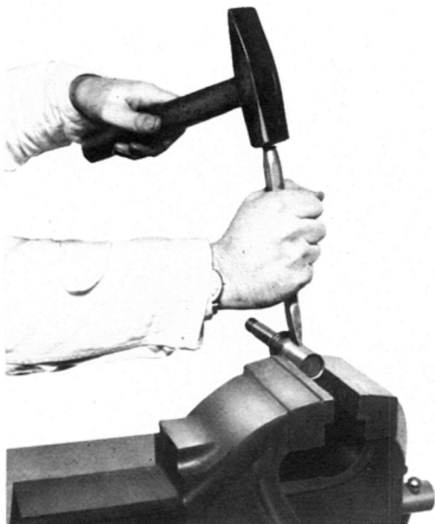
Fig. 19 — Corte do Tubo Interno da Bucha
