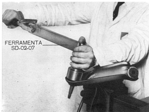
Fig. 22 — Remoção da junta do braço de contrôle superior
