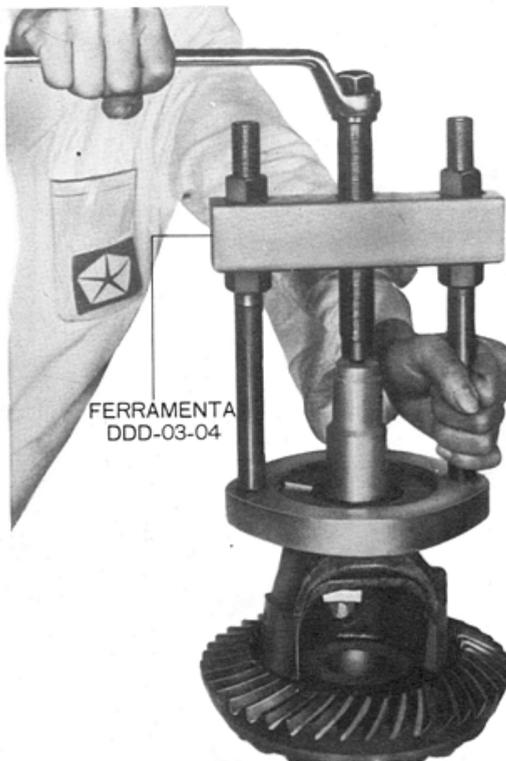
Fig. 5 — Remoção dos rolamentos da caixa de satélites
