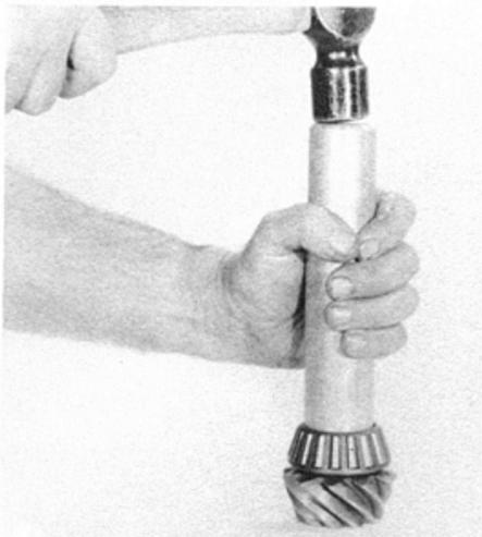
Fig. 36 - Instalação do cone do rolamento interno
