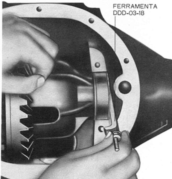
Fig. 26 — Calibrador de lâminas especial
