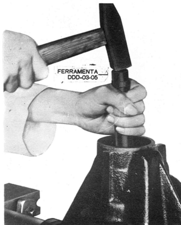
Fig. 9 — Remoção da capa do rolamento traseiro do pinhão
