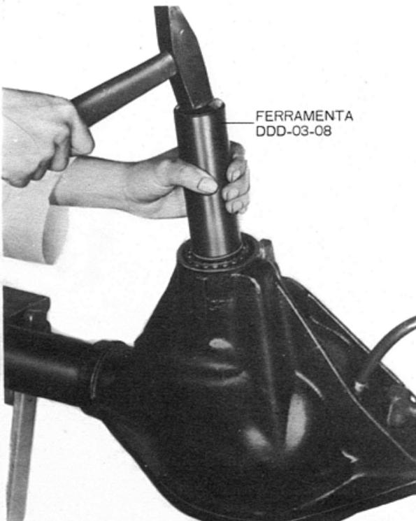
Fig. 21 — Instalação do rolamento dianteiro do pinhão
