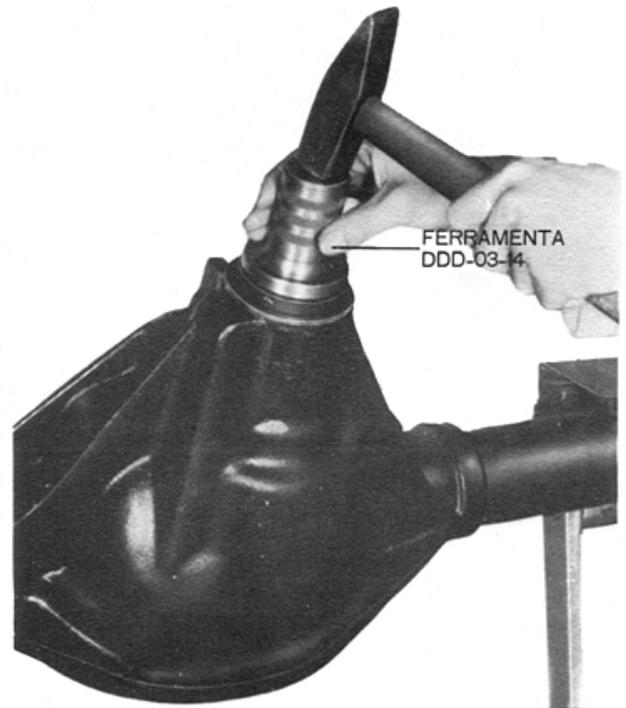
Fig. 22 — Instalação do vedador de óleo do pinhão
