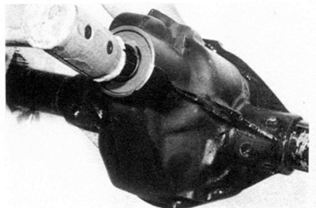
Fig. 21 - Remoção do pinhão.
