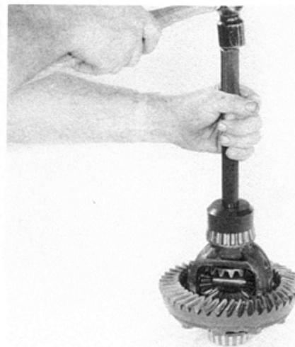
Fig. 43 - Instalação do cone do rolamento sobre os calços.
