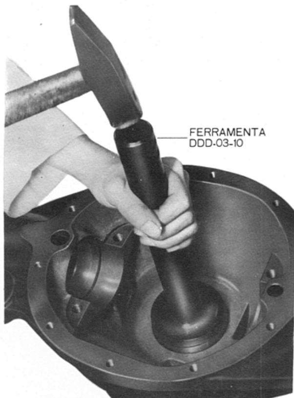
Fig. 17 — Instalação da capa do rolamento traseiro do pinhão
