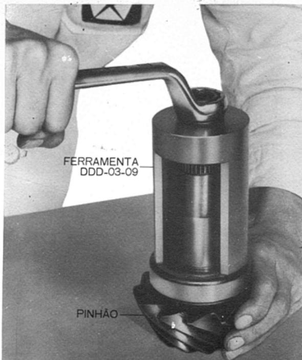
Fig. 13 — Fixação com a ferramenta especial da capa do rolamento
