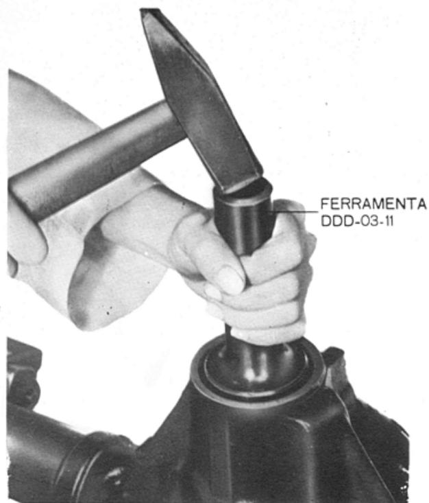
Fig. 18 — Instalação da capa do rolamento dianteiro do pinhão
