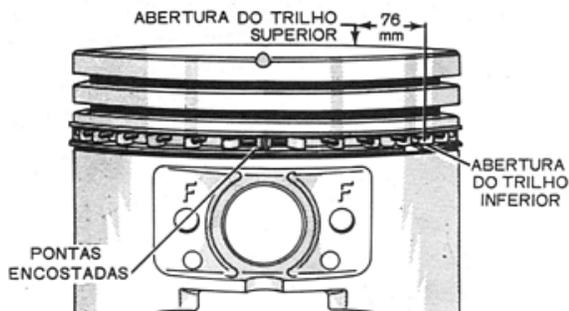
Fig. 33 — Instalação correta do anel raspador de óleo
