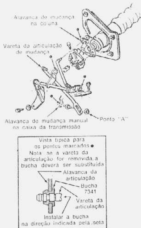
fig. 23 — articulações de controle da transmissão
