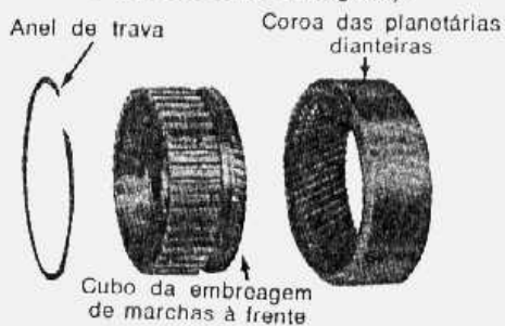
fig. 83 — cubo da embreagem de marchas para frente e coroa das planetárias dianteiras, desmontadas
